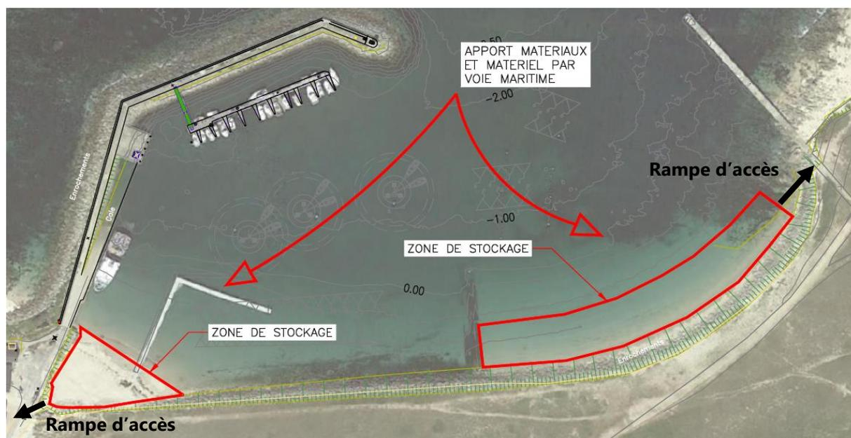
FIGURE 4 : LOCALISATION DES RAMPES D'ACCES AUX ZONES DE STOCKAGE DES MATERIAUX
